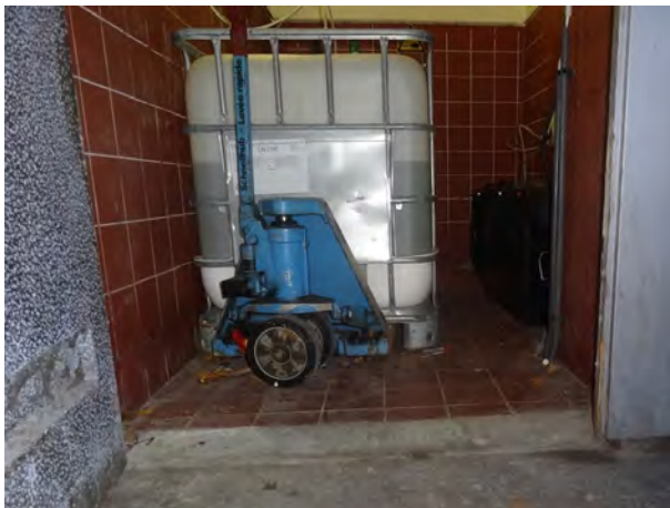
Lagertank aus Kunststoff mit verzinktem Stahlrohrrahmen
