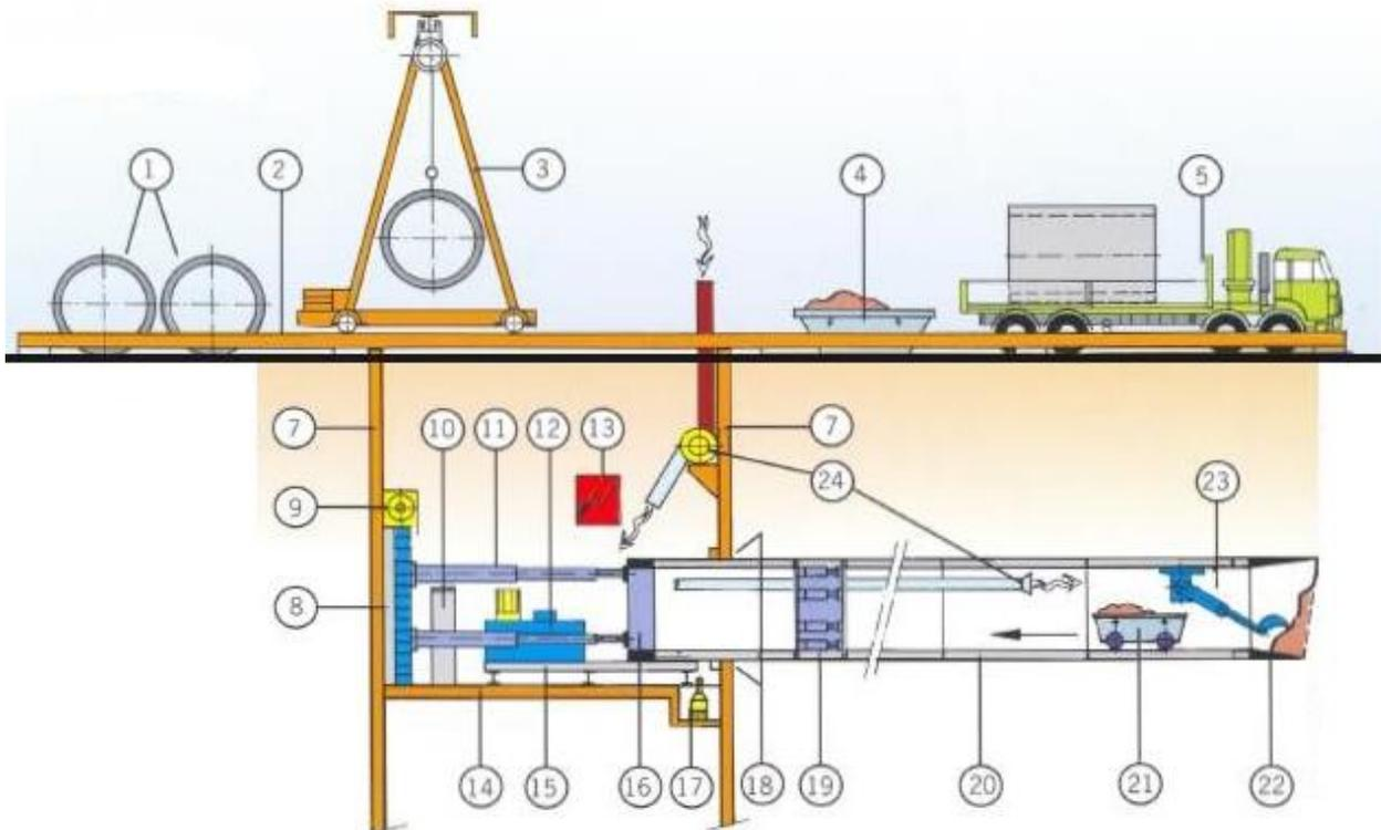
Der Pressrohrvortrieb im Querschnitt: (11) Die Presszylinder in der Startgrube. (19) Eine erste Zwischenpress-Station.
