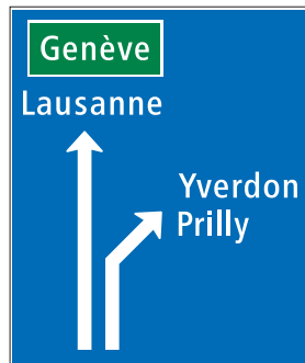
4.38 Vorwegweiser mit Fahrstreifenaufteilung auf Hauptstrassen (Art. 52)
