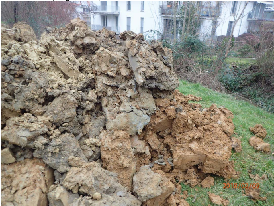
SS1 Aushubmaterial: Moräne (grau-braun, oben), Schwemmlehm (braun, unten, rechts)
