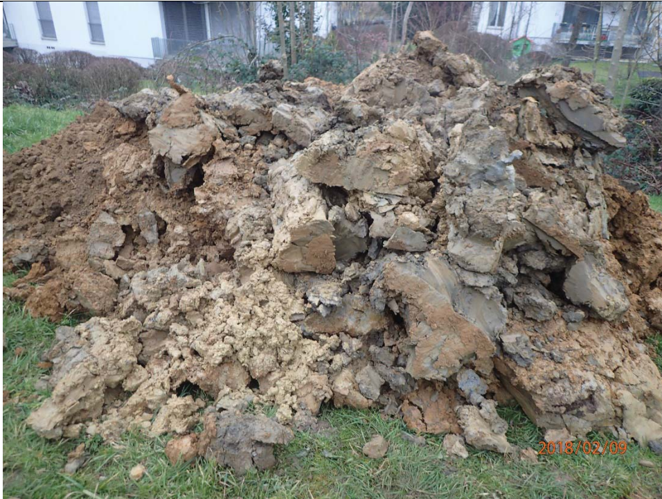
SS1 Aushubmaterial: Schwemmlehm (braun im Hintergrund), Moräne (grau-braun), Hochterrassenchotter (beige, vorne)
