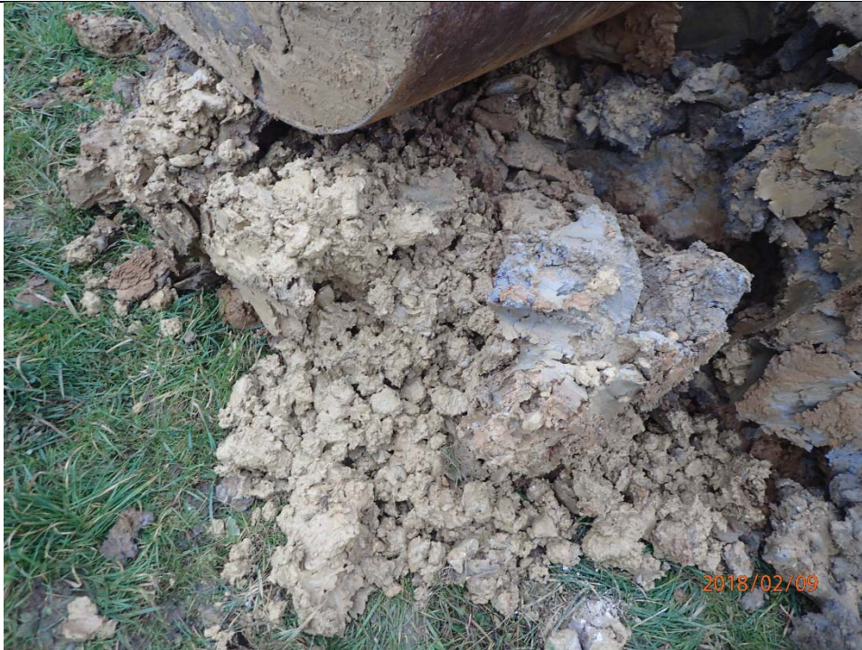
SS1 Aushubmaterial: Hochterrassenschotter (beige) und Moräne (gräulich)
