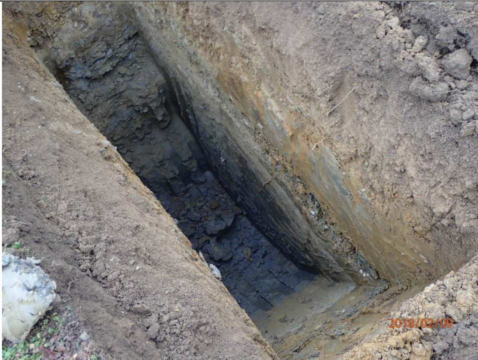
SS2 Sondierschlitz: Schwemmlehm – kiesige Moräne - Obdusustone
