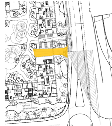
Abbildung 8: Planausschnitte Anschlussknoten, mit Nachweis Sichtbarkeiten (siehe auch Anhang)
