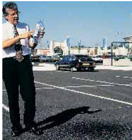
«Vittel-Test»: Die 1,5 l Wasser versickern augenblicklich
